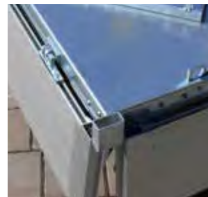
Alu-Bordwände vierseitig abklapp- und abnehmbar
