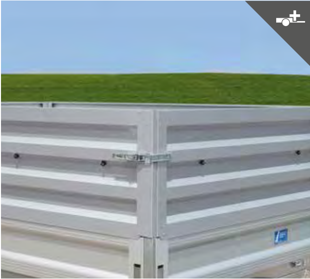
Leichtgutaufsatz für mehr Ladevolumen z. B. von Geäst oder Rasenschnitt
