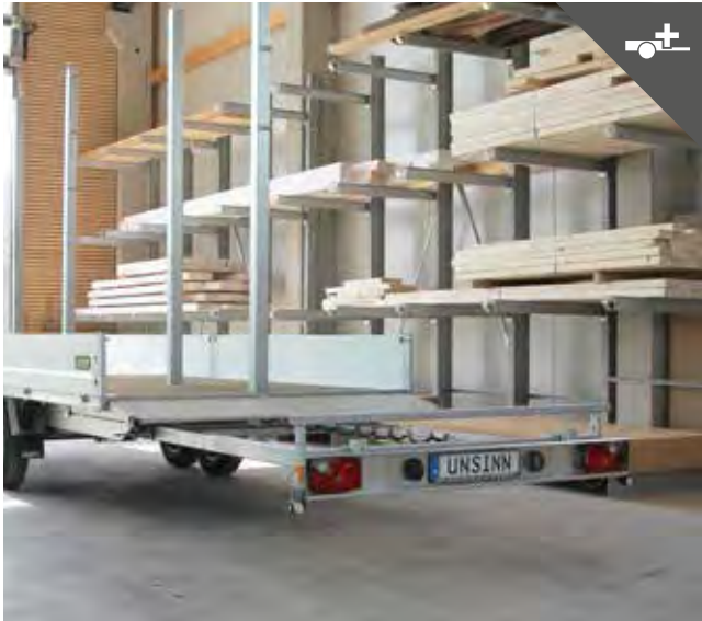
Heckleuchenträger bis 2000 mm ausziehbar
