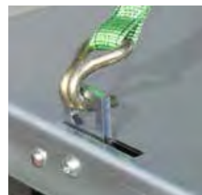
6 - 8 versenkte Zurringe mit je 600 kg Zugkraft
