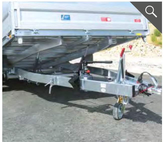
Verschweißter und feuerverzinkter Stahlrahmen
