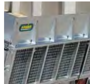
Durchgehende Stahlgitterauffahrklappe mit Alu-Riffelblech belegt
