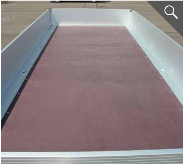
Ladefläche: durchgehende Siebdruckplatte (18 mm) bis 4.260 x 2.040 mm
